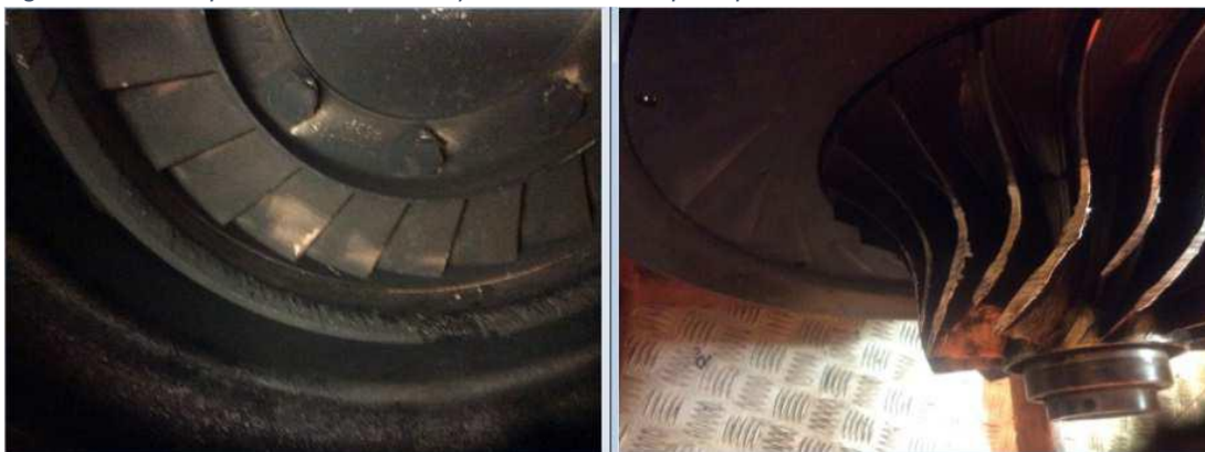
Figura 30: Componentes danificados da turbina
