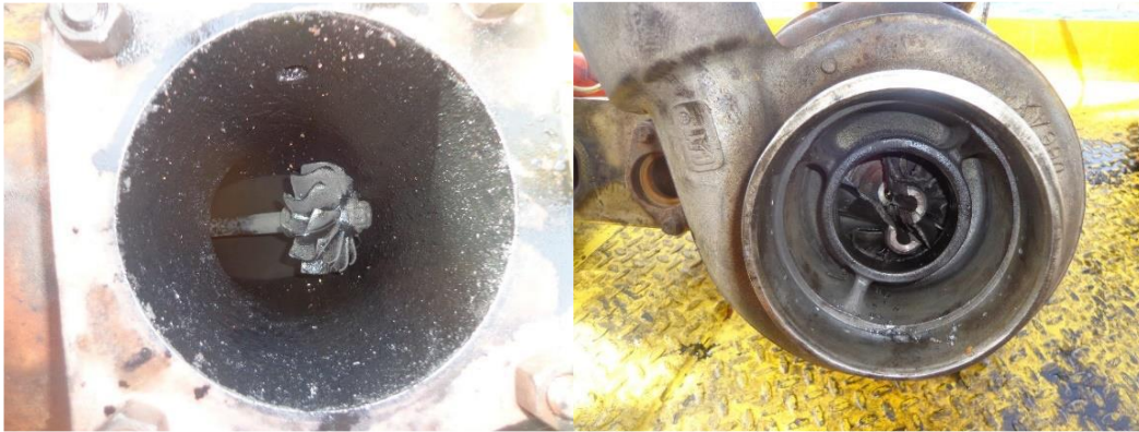
Figura 32: Eixo onde originou a falha do turbocompressor defeituoso.
