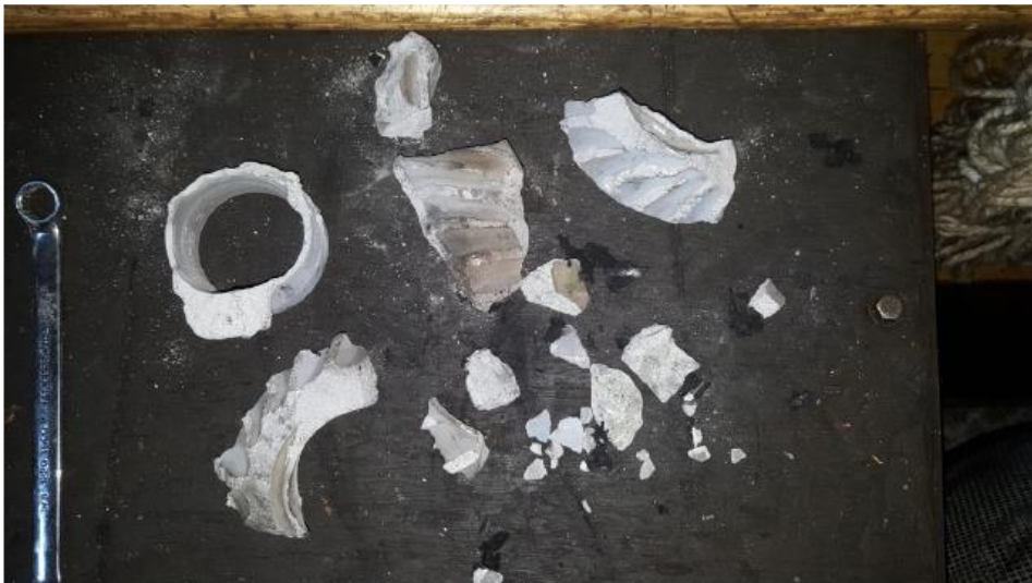
Figura 31: Pedacos desintegrados do impedor retirados na admissão de ar do turbocharger.
